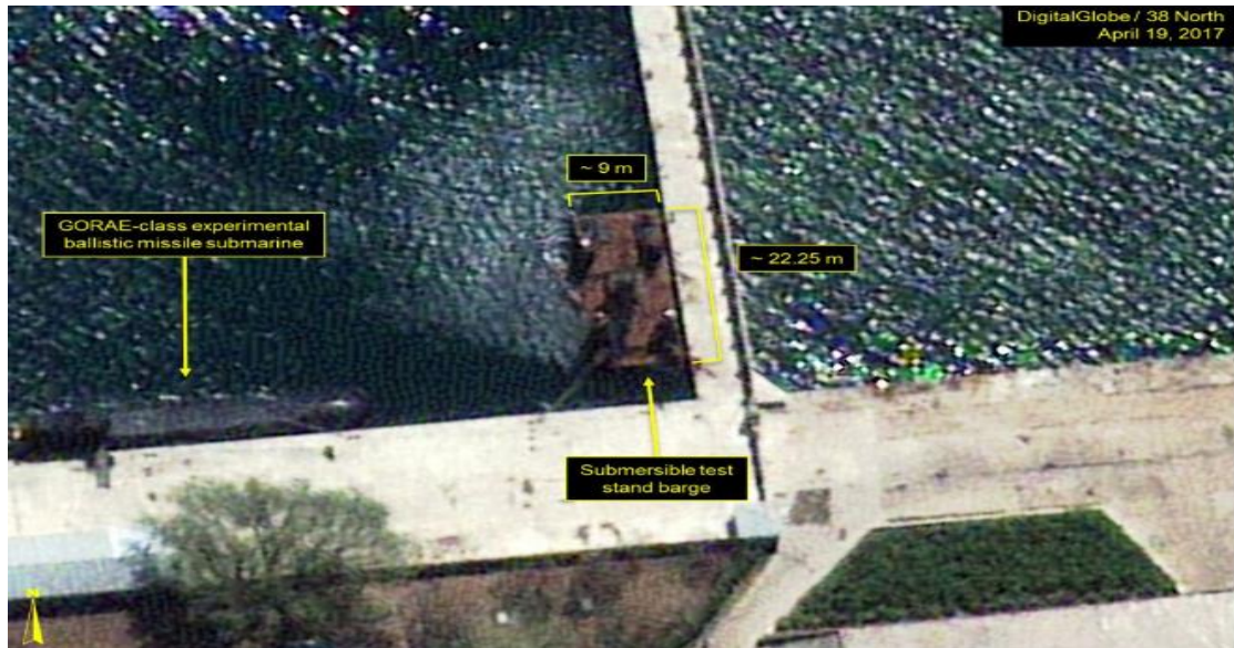
Εικόνα 5: Εντοπισμός Υποβρυχίου με Πυρηνικούς Πυραύλους με βυθιζομενη Φορτηγίδα Δοκιμών (Πηγή : 38 North)
